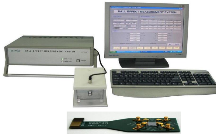
Şekil 4.23. HMS3000 Hall etkisi ölçüm sistemi ve yaylı örnek tutucusu
