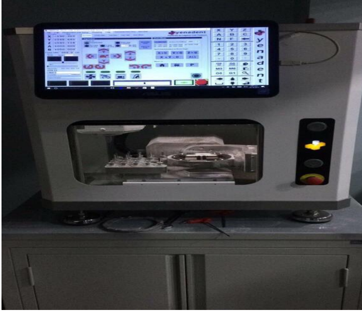
Resim 2: Titanyum örneklerin hazırlandığı freze makinası
