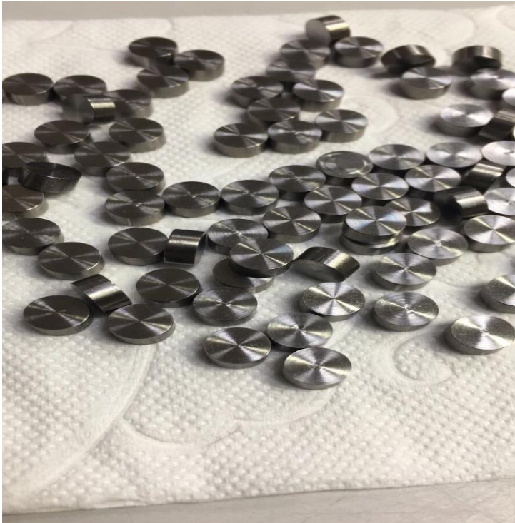
Resim 3: Titanyum disklerin CAD/CAM cihazından elde edilmesi sonrası oluşan titanyum silindir disk görüntüsü
