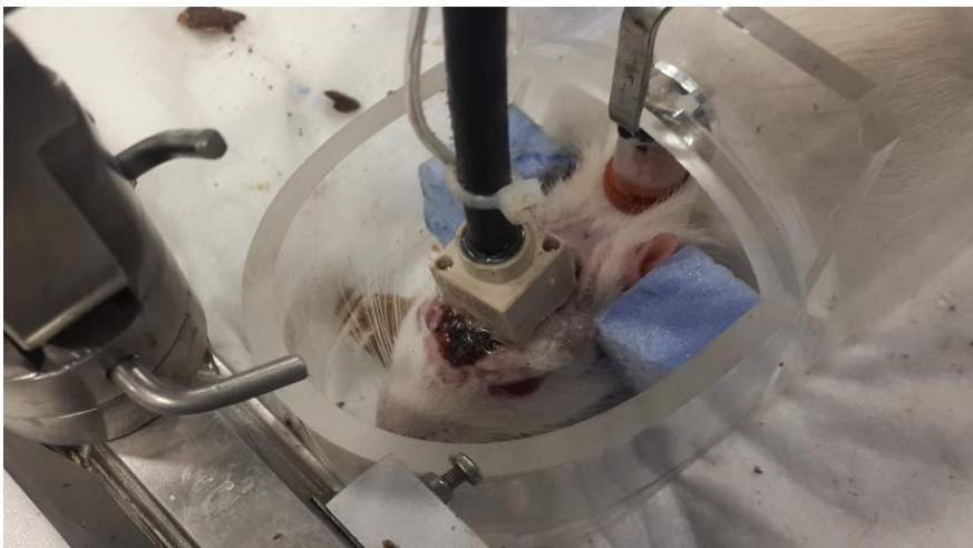
Şekil 36: Düşük yoğunluklu odaklanmış ultrason uyarımı görüntüsü, rat sabitleme aparatında
