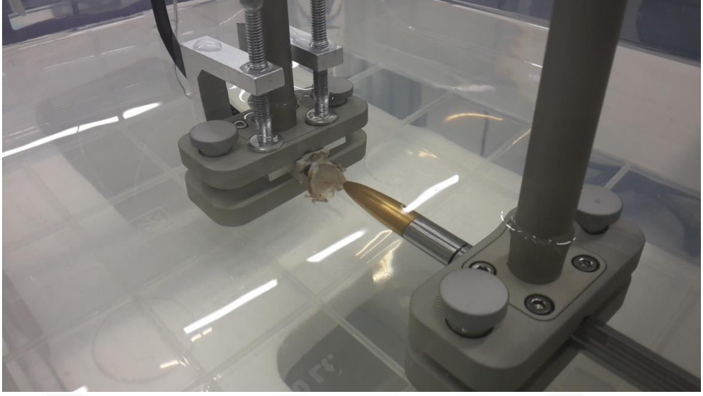
Şekil 11: Kafatası ile perdelenmiş olan Transducerin Bullet Hydrophone ile Karakterizasyonu
