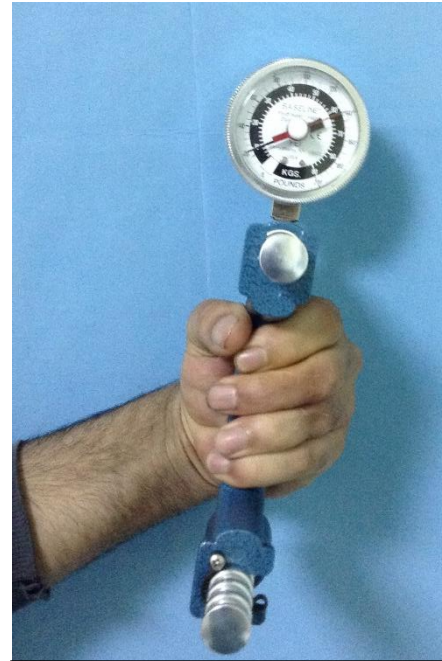
Şekil 28: Dinamometre ile Kavrama Gücü Ölçümü
