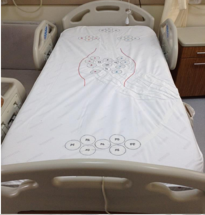
Şekil 14. Akıllı Çarşafın prototipi ve örnek hastada basınç monitörizasyonu.
