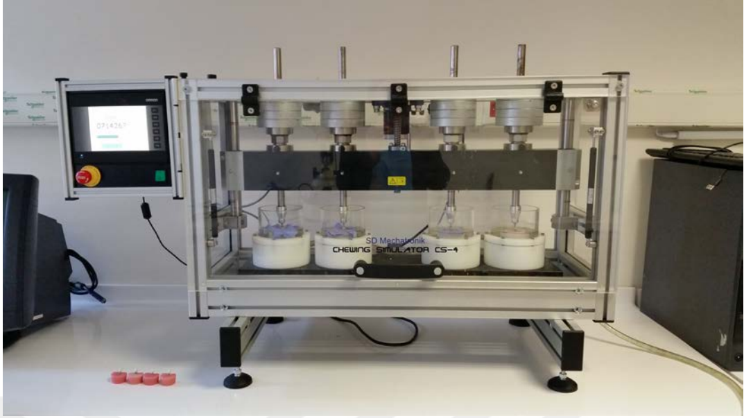
Resim 9. Örneklerin Çiğneme Simülöründe yorulması
