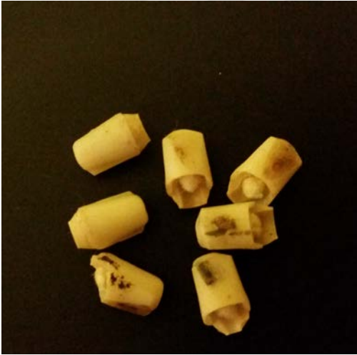
Resim 14. Kırılan zirkonya abutment örnekleri
