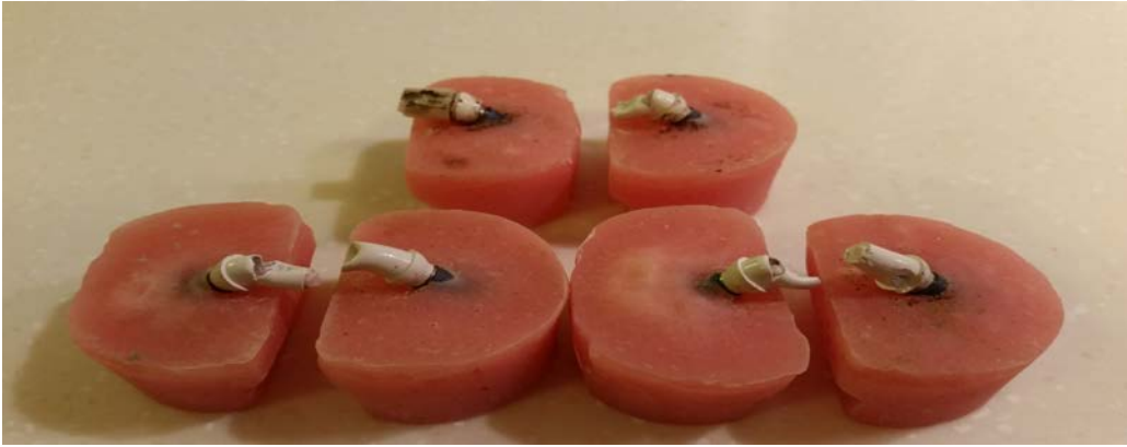
Resim 16. Korları kırılan ve kırıldıktan sonra yük uygulamaya devam edilen ve deforme olan peek abutment örnekleri
