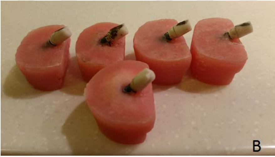
Resim 17. A a, b Korları kırılmayan peek abutmentların eğilme derecesinin herhangi bir uygulama yapılmamış olanıyla karşılaştırılmasının görüntüsü
