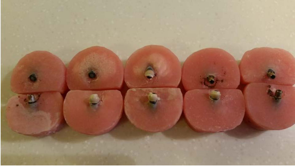
Resim 13. Akrilik içinde kırılan zirkonya abutment örnekleri
