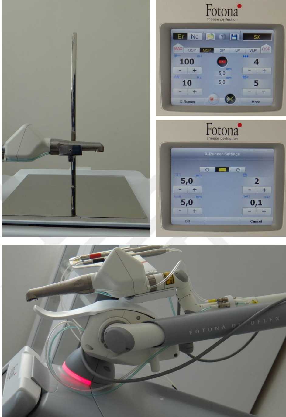
Şekil 3-6. Çalışmamızda kullanılan Xrunner lazer cihazı,düzeneği ve parametreleri
