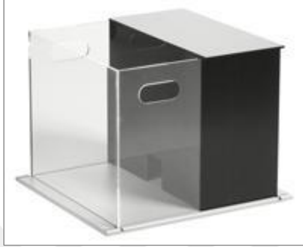
Resim 10. Aydınlık/karanlık test düzeneđi
