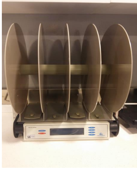
Resim 15. Rotarod testi materyali
