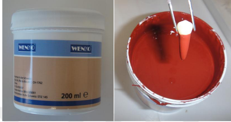
Şekil 3.18 : Otopolimerizan silikonun (Anti-Rutsch-Lack; Wenko, Wensselaer, Almanya) periodonsiyumu simüle etmesi amacıyla dişlerin köklerinin kaplanması.
