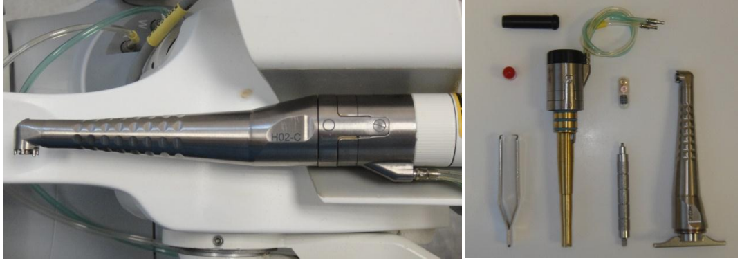
Şekil 3.6: Er:YAG lazer cihazı H02-N temassız(non-kontakt) el aleti 90° açılı 0.9 mm nokta çapı hava ve su soğutmalı (Lightwalker, Fotona).
