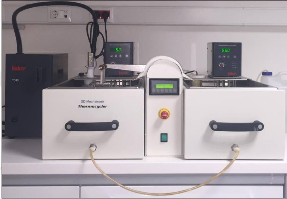
Şekil 1.12: Çalışmada kullanılan termal siklus cihazı (SD Mechatronik Thermocycler, GMBH, Westerham, Almanya).
