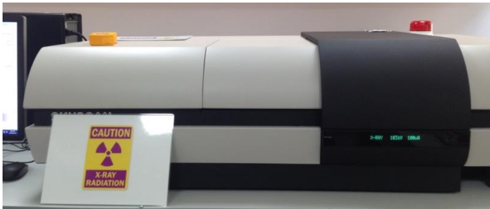
Şekil 3.11: Mikro-BT sistemi (SKYSCAN 1172, Bruker microCT, Kontich, Belçika).
