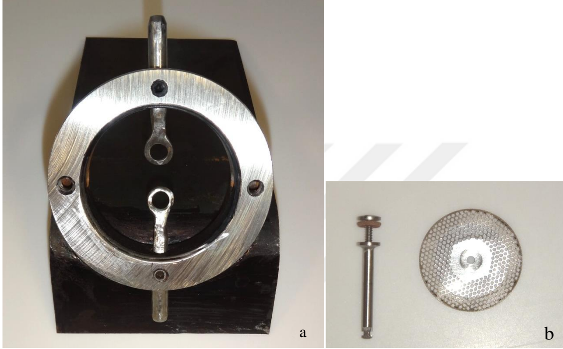
Resim 3: a) Ratların kesici dişlerini sabitlemek için kullanılan bu çalışma için tasarlanmış düzenek b) Keser dişlere retansiyon oluğu oluşturmak amacıyla kullanılan separasyon frezi
