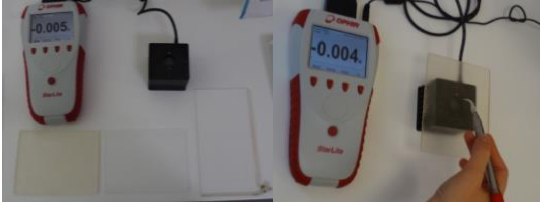
Şekil 3.6: Powermetre cihazı (Ophir, StarLite P/N 7Z01565, Danvers, Massachusetts, ABD) ile lazer ışını geçirgenliğinin ölçümü.
