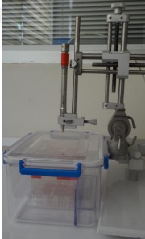
Şekil 3.16: Stereotaksik aparat yardımıyla lazerin sabitlenmesi.
