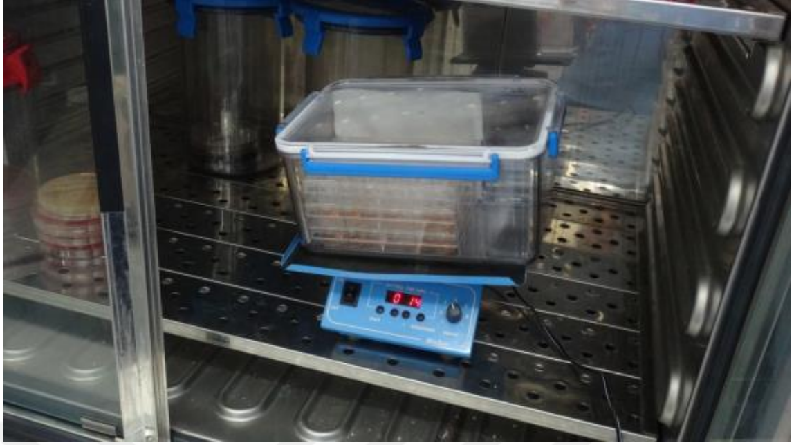
Şekil 3.13: Bakterilerin anaerop ortamda, çalkalayıcıda inkübe edilmesi.
