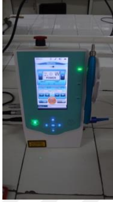
Şekil 3.2: 810 nm diyet lazer cihazı (Cheese, DEN4A model, Wuhan Gigaa Optronics Technology Co. Ltd., Wuhan, Çin Halk Cumhuriyeti).
