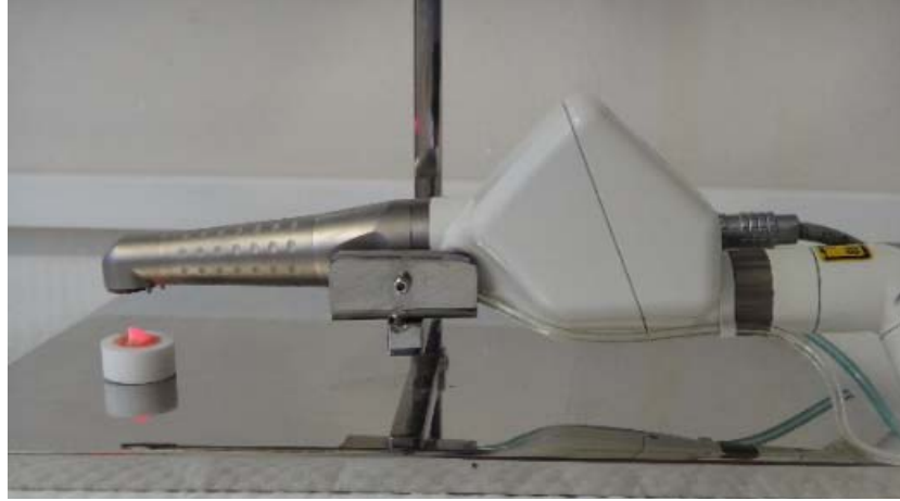
Şekil 29: X-Runner ile pürüzlendirme: Stabilizatöre monte edilmiş SX02-H başlığı.
