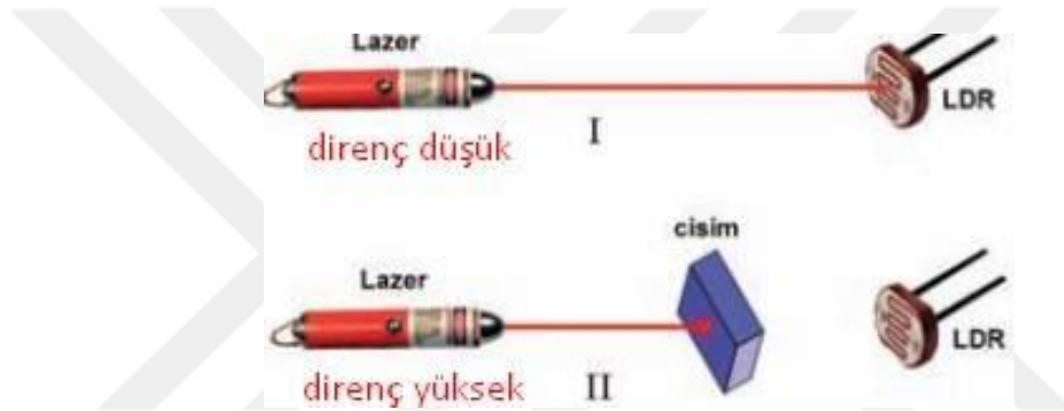
Şekil 20. Elektronik Işık Sensörlü Hırsız Alarm Şeması Genel Görünümü
