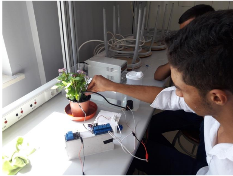
Şekil 10. Toprak nem ölçme sensörlü otomatik çiçek sulama devresi ve devre denemesi
