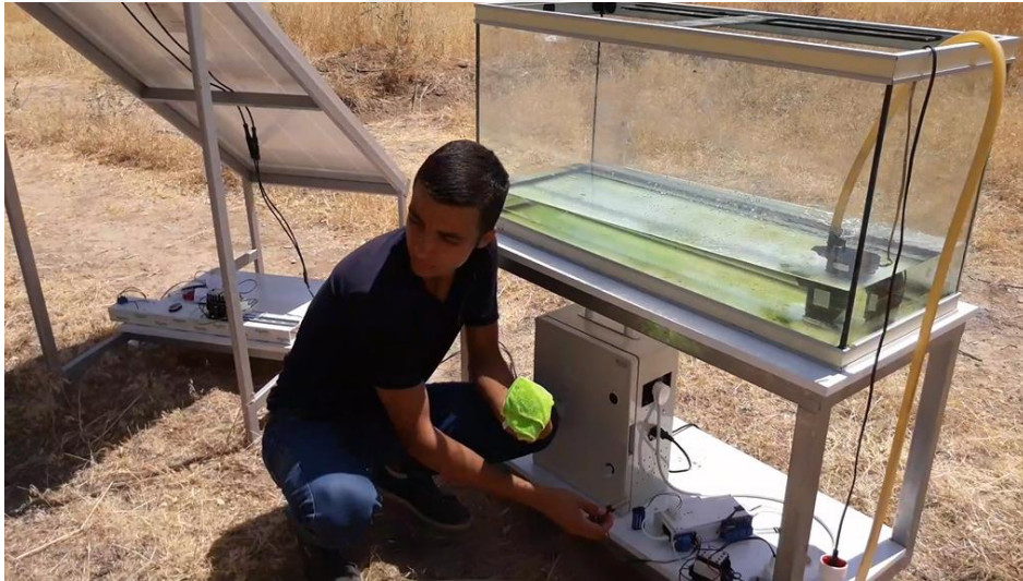
Şekil 4. Güneş Enerjili, Toprak Nem Ölçme Sensörlü Otomatik Kayısı Sulama Sistemi Uygulaması
