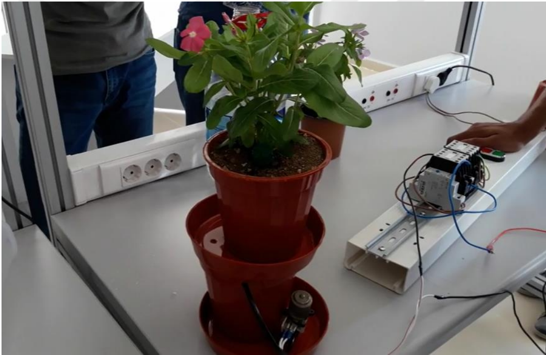
Şekil 14. Zaman röleli otomatik çiçek sulama devresi ve devre denemesi
