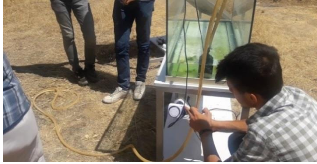
Şekil 8. Güneş Enerjili, Mekanik Zaman Ayarlı Otomatik Kayısı Sulama Sistemi Denemesi
