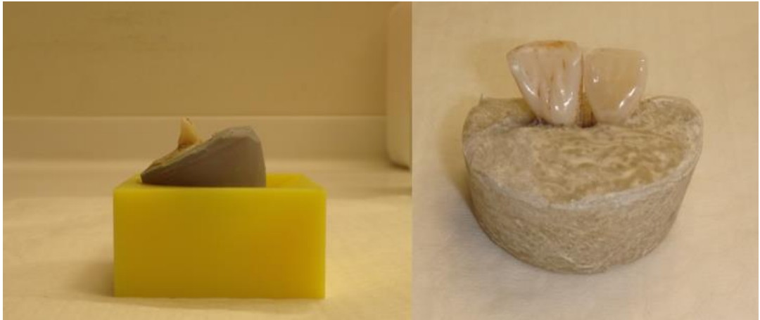
Şekil 3.5: Dişlerin Technovit 4000 içine gömülmesi.
