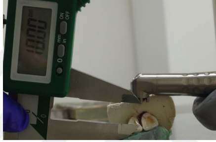
Şekil 3.9: Örneklerin lazerle pürüzlendirilmesi.
