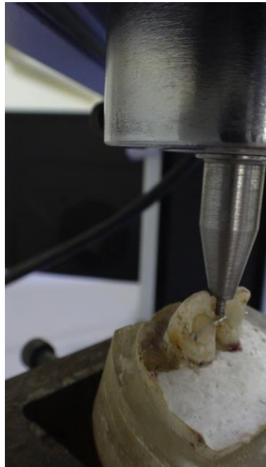
řekil 3.21: Universal test cihazında (Shimadzu Co., Tokyo, Japonya) bađlanma dayanımı testinin yapılması.
