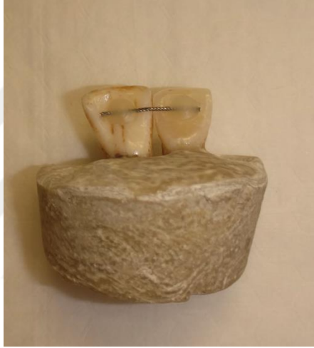
Şekil 3.11: Çiğneme simülatöründe test için hazırlanan örnekler.
