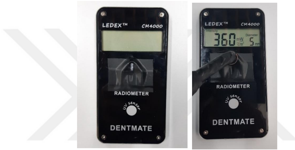
Şekil 3.3 : Braketlerin LEDex Cm 4000 Radiometre cihazı ile ışık geçirgenliği değerinin ölçümü.
