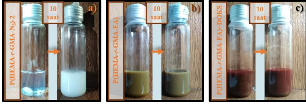
Şekil 4.29 : a) P(HEMA- r -GMA-N 3 )-2, b) P(HEMA- r -GMA-FA) ve c) P(HEMA- r -GMA-FA) + DOKS makroRAFT ajanları kullanılan sistemlerin polimerizasyon öncesi ve sonrası fotoğrafları.
