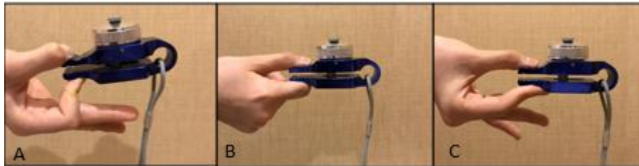
Şekil 3.2: Çimdik kavrama kuvveti ölçümü (A: Parmak ucu kavrama, B: Lateral kavrama, C: Palmar kavrama).
