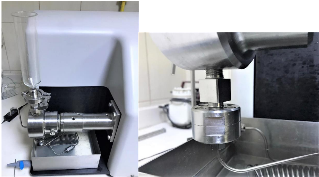
Şekil 3.3 : Microfluidizer LM20 cihazı, cihazın kalbi olan özel etkileşim odası (sağ).
