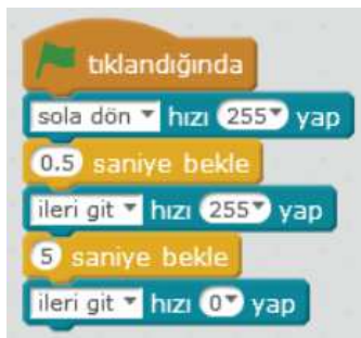
Şekil 10. Robotu sola doğru 50 cm ileri götüren kod bloğu
