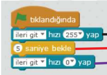
Şekil 5. Robotu 50cm ileri götüren kod bloğu
