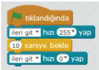
Şekil 5. Robotu 50cm ileri götüren kod bloğu
