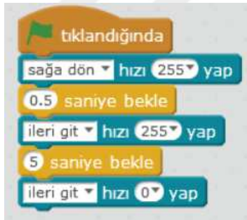
Şekil 9. Robotu sağa doğru 50 cm ileri götüren kod bloğu
