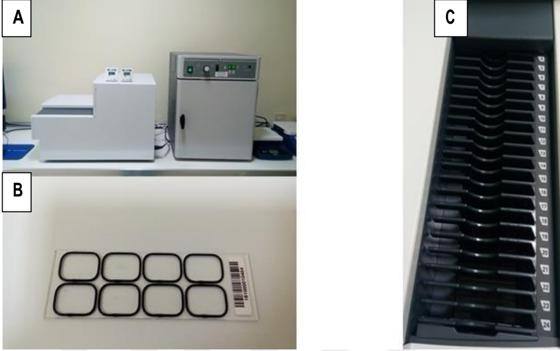
Şekil 3.1. aCGH tarayıcı-fırın malzemeleri Şekil 3.1. A'da sağda array problemlerinin hibridizasyon işleminin gerçekleştiği hibridizasyon fırını solunda ise fırından çıkan problemlerin taramasının yapıldığı, ham datanın oluşturulduğu tarayıcı ((AGT-G4900DA SureScan Microarray Scanner) bulunmaktadır. Şekil 3.1. B'de hasta ve referansa ait DNA'nın hibridizasyonunun gerçekleştiği(fırına yerleştirilen) ve üzerinde array problemlerinin bulunduğu 60Kx8'lik array kiti, Şekil 3.1. C'de tarayıcının cam slayt yerleştirilen gözleri görülmektedir.
