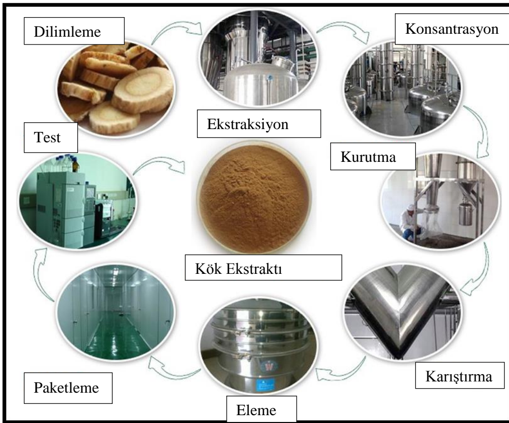
Şekil 1. Astragalus kök ekstraksiyonu işlem şeması
