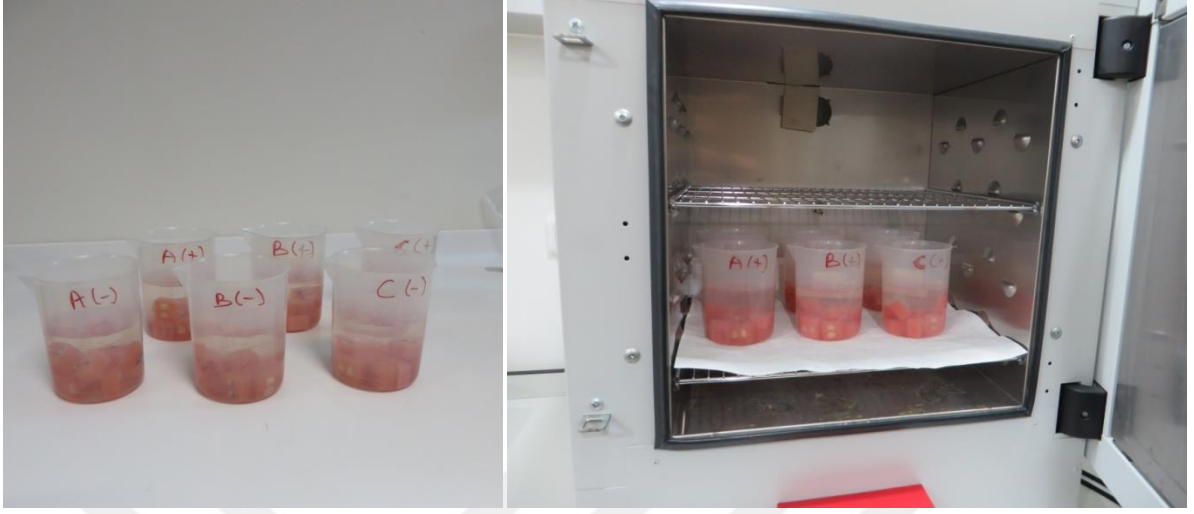
Resim 5-6. Çalışma gruplarının de/remineralize solüsyonda ve etüvde bekletilmesi
