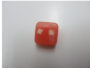
Resim 2. 5x5x2 mm boyutlarında hazırlanan mine bloklarının akrilik bloklara gömülmesi
