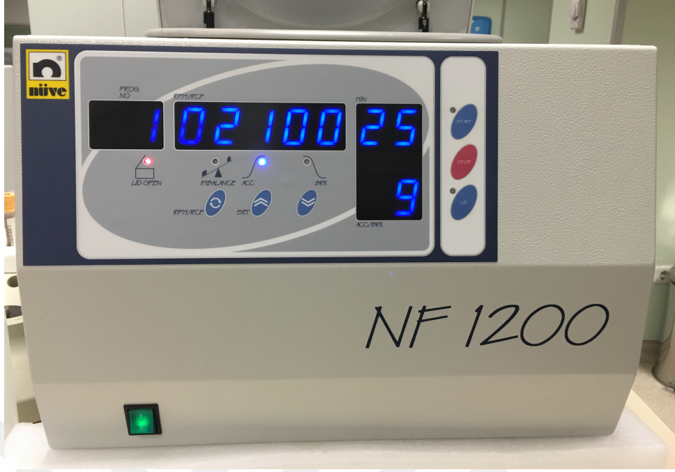
Resim 2. Venöz kan örneklerinin santrifüjü için kullanılan NF 1200 santrifüj cihazı
