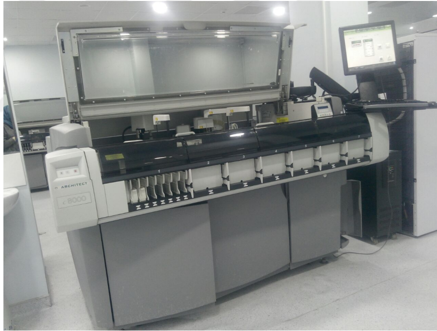
Resim 4. Spektrofotometrik ölçümler için kullanılan Abbott ARCHITECT c4000 Clinical Chemistry Analyzer
