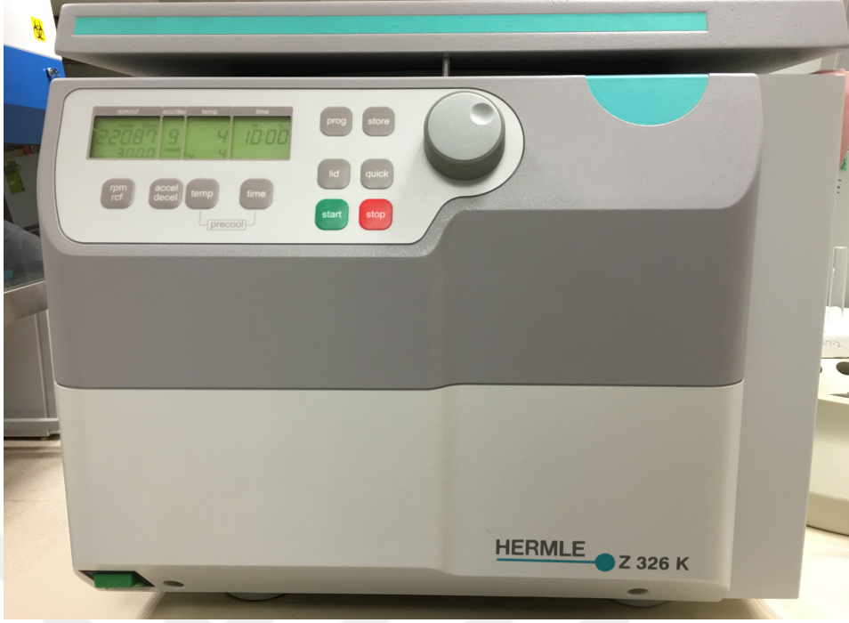
Resim 1. Tükürük örneklerinin santrifüjü için kullanılan Hermle Z326 K santrifüj cihazı
