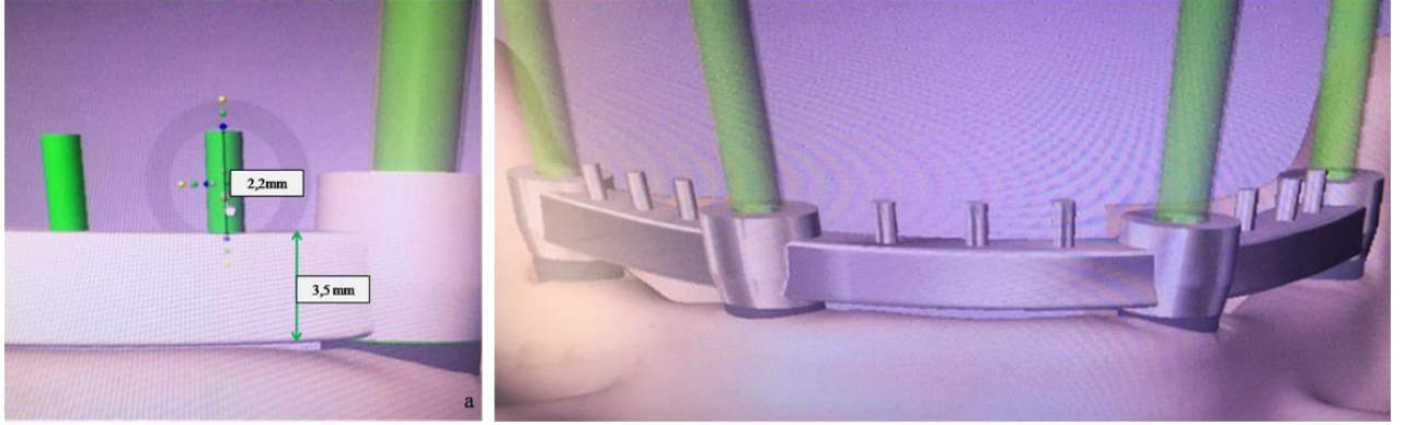
Şekil 16. a) Hibrit protez altyapısı üzerindeki 2,2 mm'lik silindirik parçalar b) Dizayn programı (DWOS yazılım, Dental Wings Inc, Montreal, Kanada) ile tasarlanmış hibrit protez altyapısı
