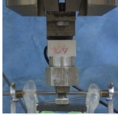
Şekil 35. Yük hücresi, yükleme ucu ve çelik levha görünümü
