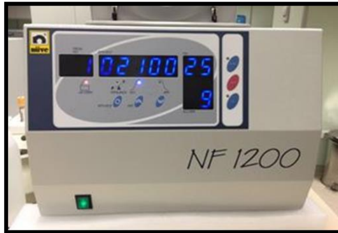
Resim 4. Venöz kan örneklerinin santrifüjü için kullanılan cihaz (Nüve NF1200)
