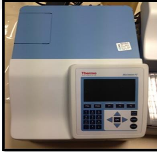
Resim 7. Mikroplak optik okuyucu; Spektrofotometre (Thermo Scientific Multiskan FC, 2011-06, USA)
