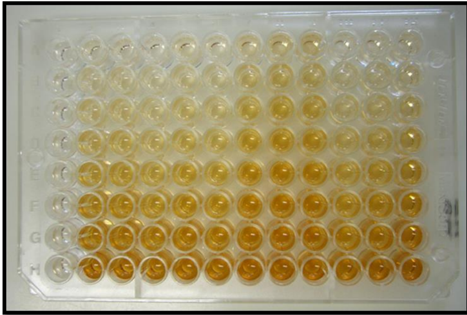
Resim 11. NO konsantrasyonuna bağlı gelişen renk reaksiyonu (Nitric Oxide Assay Kit) (Colorimetric) (abcam; REF: ab65328)
