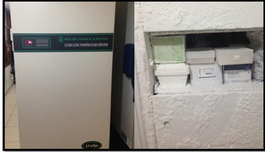
Resim 3. Örneklerin saklandığı -80°C dondurucu (New Brunswick Scientific, Model: C54285)
