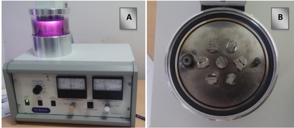
Resim 10. A: Örneklerin altın-paladyum kaplandığı sputter coater cihazı B: Altın-paladyum kaplanmış örnekler
