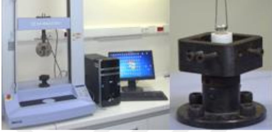
Şekil 3.10: Shimadzu universal test cihazı (Shimadzu Co.,Tokyo Japonya).
