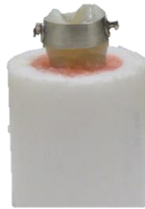
Şekil 3.9: Kalıp içinde akriliğe gömülmüş diş örneği.
