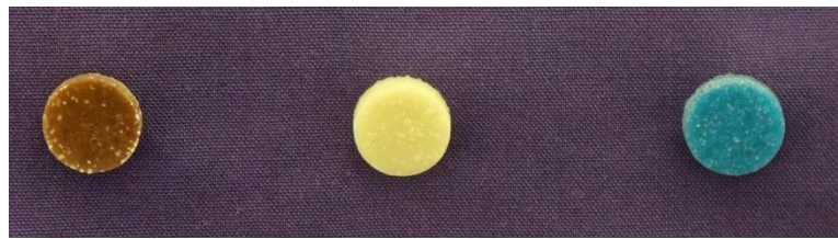
Şekil 3.15: Ag nanopartikülü eklenmiş siman materyalinden hazırlanan diskler.
