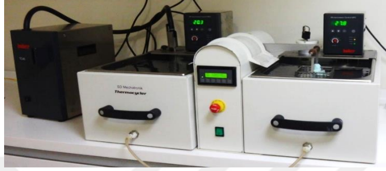
Şekil 3.8: Termal siklus işleminin yapıldığı cihaz (SD Mechatronik Thermocycler, Feldkirchen-Westerham Almanya).
