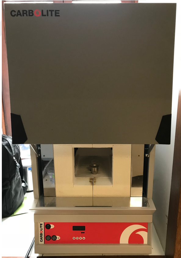
Şekil 3.4. Biyoaktif cam materyalinin son fırınlama işlemi için platin kroze içerisinde fırına yerleştirilmesi
