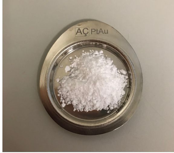
Şekil 3.5. Sol-jel yöntemiyle elde edilen biyoaktif cam nanopartikülleri
