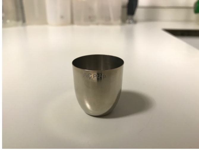
Şekil 3.1. Biyoaktif cam üretiminin gerçekleştiği platin kroze
