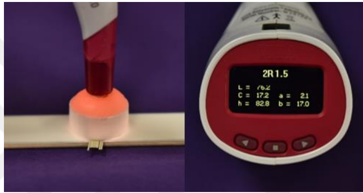
Şekil 3-7: VITA Easyshade Compact (VITA Zahnfabrik, Bad Sackingen, Almanya, Model DEASYC220) spektrofotometre cihazı ile renk ölçümü.
