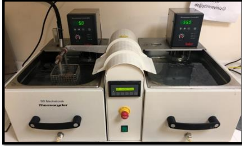
Şekil 3.8 : Termal Siklus Cihazı (SD Mechatronik Thermocycler, Almanya).
