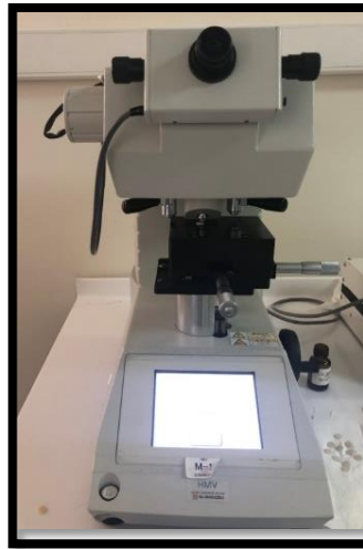
Şekil 3.11 : Shimadzu Mikrosertlik Test Cihazı HMV-2 Serisi
