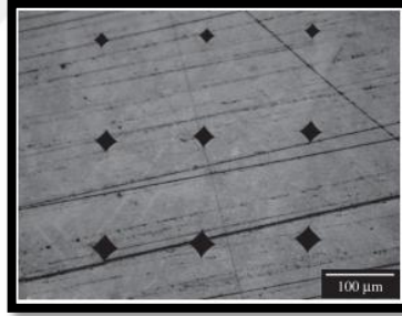
Şekil 2.10 : Farklı süre ve yükleme değerlerinde mine yüzeyinde oluşturulan bir grup Vickers mikrosertlik girintisi [130].
