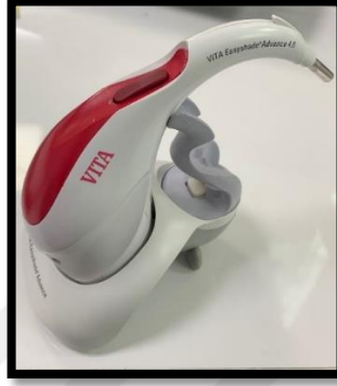
Şekil 3.10 : Spektrofotometre (Vita EasyShade Advance 4.0, Almanya) cihazı.
