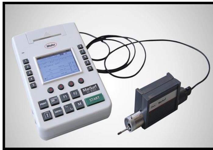
Şekil 3.9 : Konvansiyonel profilometre cihazı (MarSurf M 300 C, Almanya).
