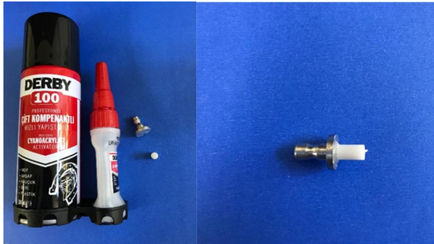
Şekil 9. Porselen silindir blokların metal parçaya sabitlenmesi.
