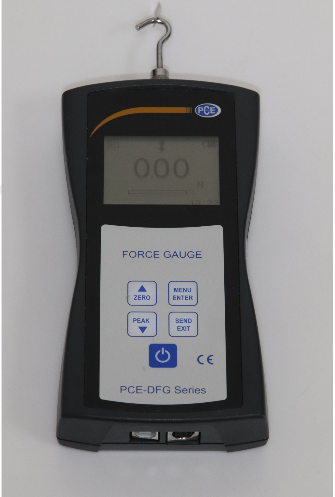
Şekil 3.1 PCE-DFG 500 Series Force Gauge cihazı.
