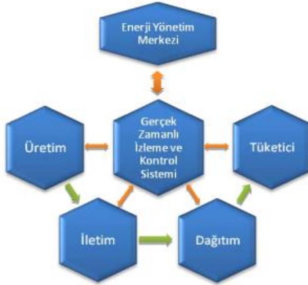
Şekil 12. Akıllı Şebeke Çalışma Şeması
