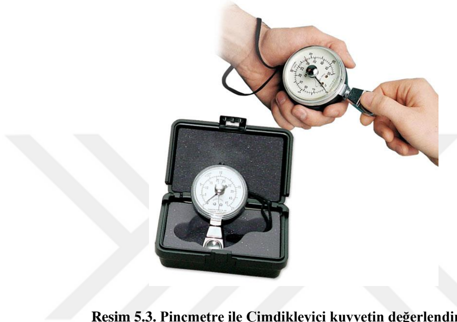
Resim 5.3. Pinçmetre ile Çimdikleyici kuvvetin değerlendirilmesi
