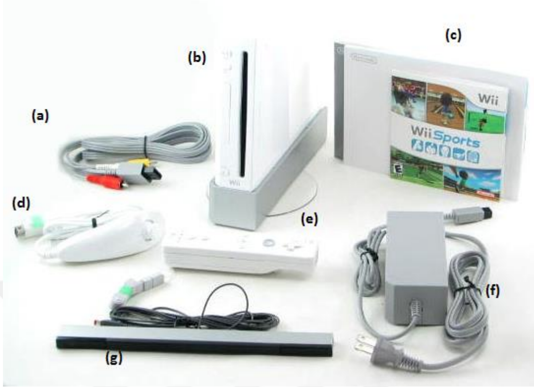
Resim 4.1. a ve f: Bağlantı kablosu, b: Oyun konsolu, c: Wii sports cd, d ve e: kontrol kumandaları, g: hareket duyarlı sensör
