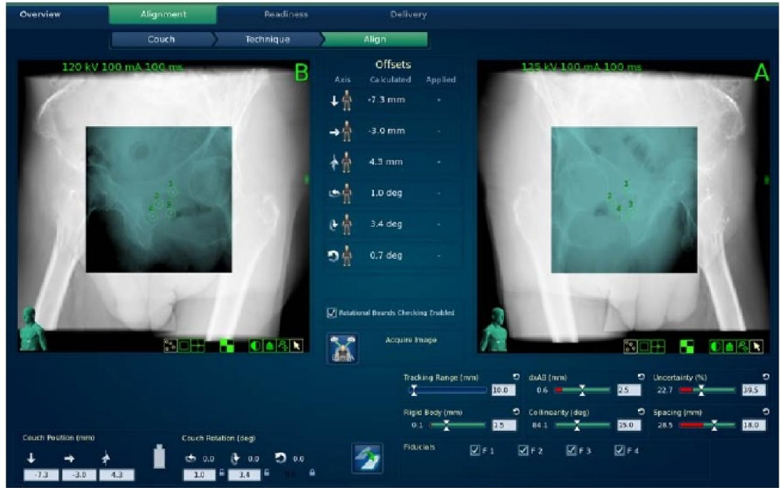
Şekil 4.3.1.6. Görüntü korelasyonu sonrasında fiducial izleme modu için eşleştirme görüntü ekranı
