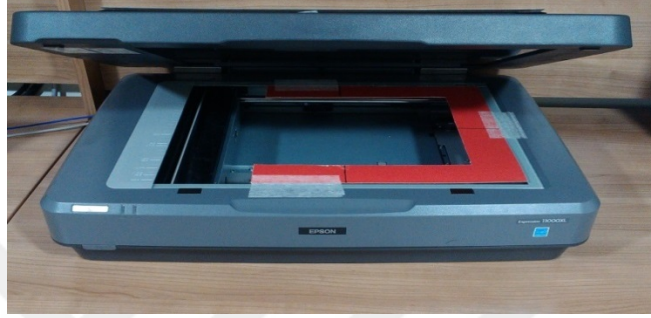
Resim 5.2.5.1. Üç kenarı mukavvadan yapılmış çerçeve ile kapatılan EPSON EXPRESSION 11000 XL tarayıcı
