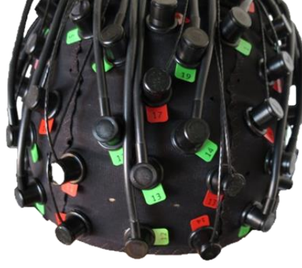
Şekil 5.3.1. : fNIRS kepi ile kaynak ve alıcılar. Temsili şekilde kırmızı numaralı optodlar kaynak, yeşil numaralı optodlar alıcıdır.
