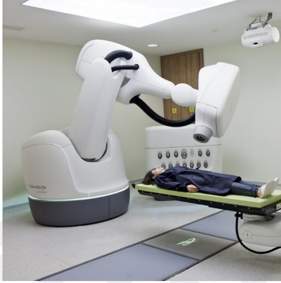
Resim 5.1.3. : Accuray CyberKnife M6 tedavi cihazı
