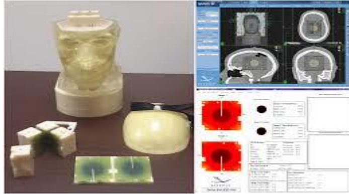
Resim 5.3.6.2 : “ballcube” adı verilen E2E test fantomu
