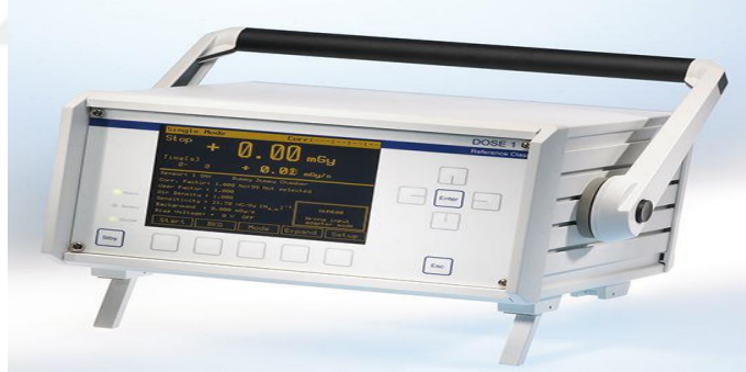
Resim 5.2.7. : Çalışmada kullanılan DOSE-1 elektrometre
