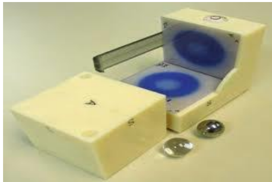
Resim 5.3.6.3: CyberKnife tedavi sisteminin izosantrik hedefleme doğruluğunu ölçmek için kullanılan AQA fantomu
