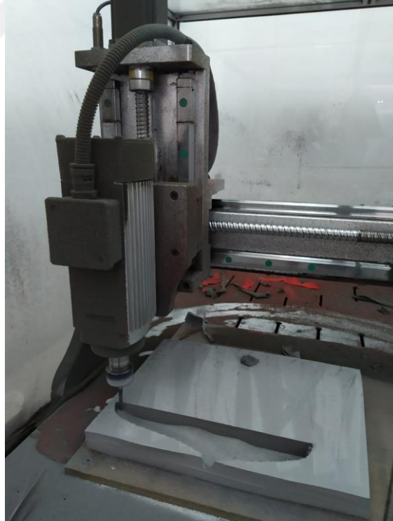
Resim 5.2.2.4 CNC Cihazından Tabanlık Üretimi
