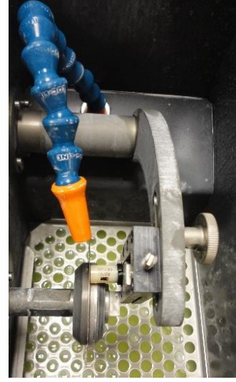
Resim 11. Örneklerin hassas kesme cihazında preperasyonu
