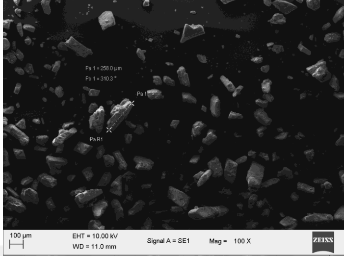
Resim 38. Sodyum bikarbonat tozu (Air Flow Classic) , 100x büyütme
