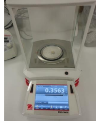
Resim 32. Hassas terazinin kalibrasyonu Resim 33. Numunenin ağırlık ölçümü
