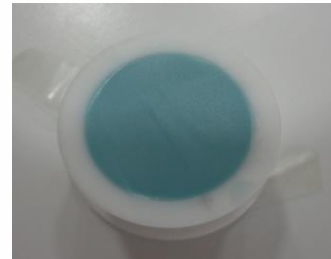
Resim 12. Örneklerin silikon kalıplara alınması
