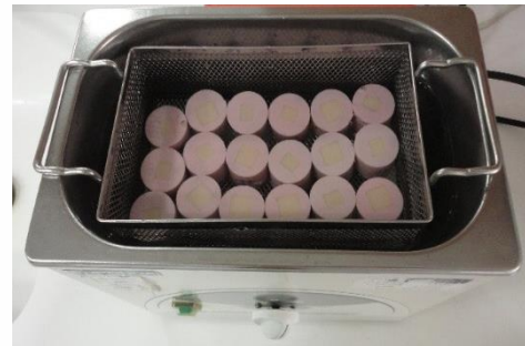
Resim 21. Örneklerin ultrasonik temizleme cihazında bekletilmesi
