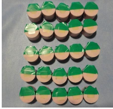
Resim 24. TEM için hazırlanan örnek yüzeylerinin su geçirmez bant ile kaplanması
