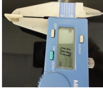
Resim 20. Örneklerin kalınlığının dijital kumpas ile kontrolü
