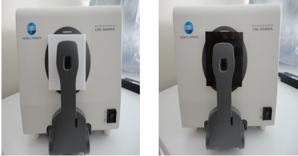
Resim 27. Siyah ve beyaz zeminlerde spektrofotometrik ölçüm yapılması
