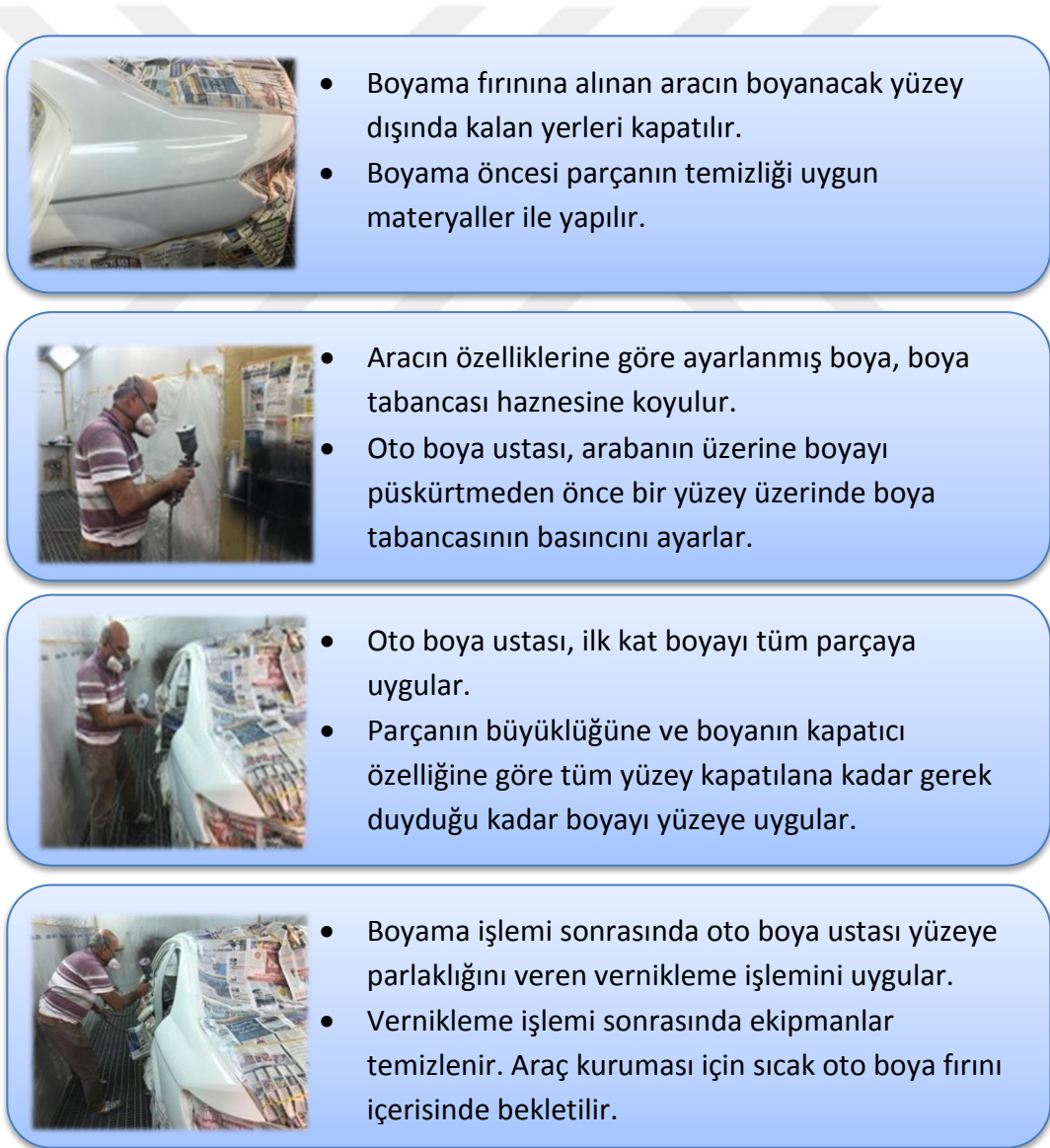
Şekil 2.3. Oto Boya Uygulama Aşamaları
