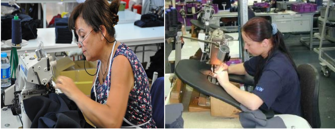
Şekil 14. Tekstil Sektöründe Vücut Merkezinden Uzakta Oturma Açısı Ve Uygun Oturma Açısı (Uğurlu, 2011).
