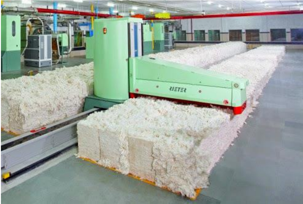
Şekil 5. Otomatik Balya Presi (Anonim, 2017).
