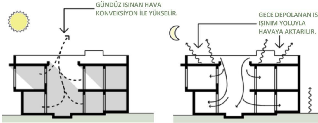
Şekil 40: Avlunun soğutma etkisi (Erdemir, 2014)
