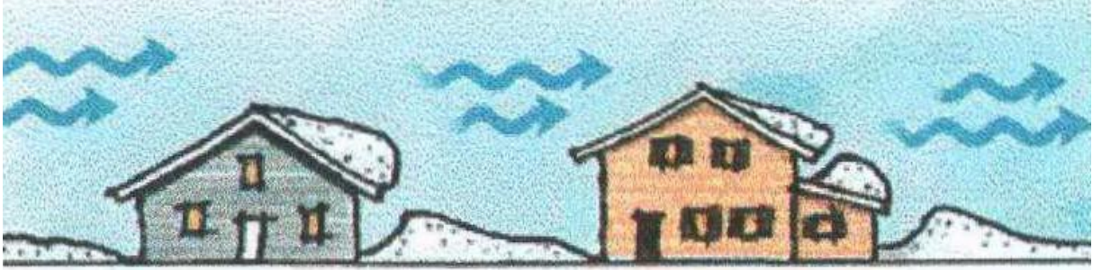
Şekil 9: Hakim rüzgar çatı eğimi ve yön ilişkisi (Akın, 2001)
