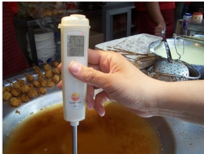
Şekil 4.9. Kadıköy ilçesinde atık yağı ısıtma denetimleri ve ölçüm çalışmaları
