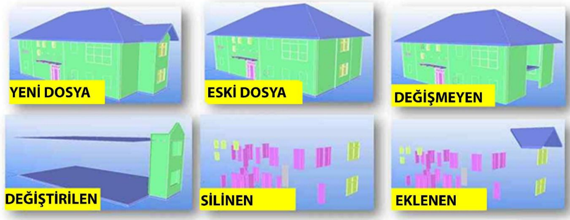
Şekil 2.4. Nelerin eklendiğini ve neyin değiştiğini gösteren BIM modelinin ara yüzleri
