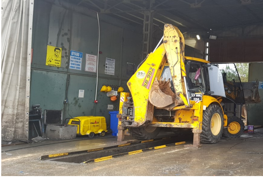
Şekil 4.17. Tamir Bakım Atölyesi Tamir Çukuru Band Uygulaması
