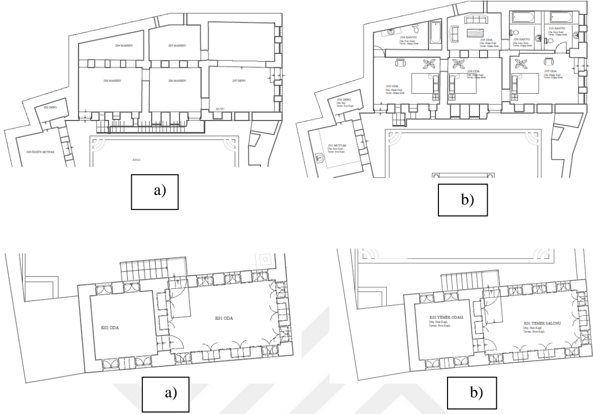
Şekil 28. Gaziantep Bey Konağı restorasyon öncesi (a) ve sonrası(b) zemin kat odaları(Kudeb,2018)
