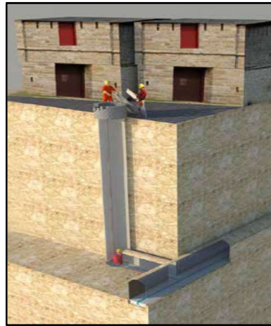
Şekil 2.2. Kuyu - Livas Bağlantısının Gösterimi
