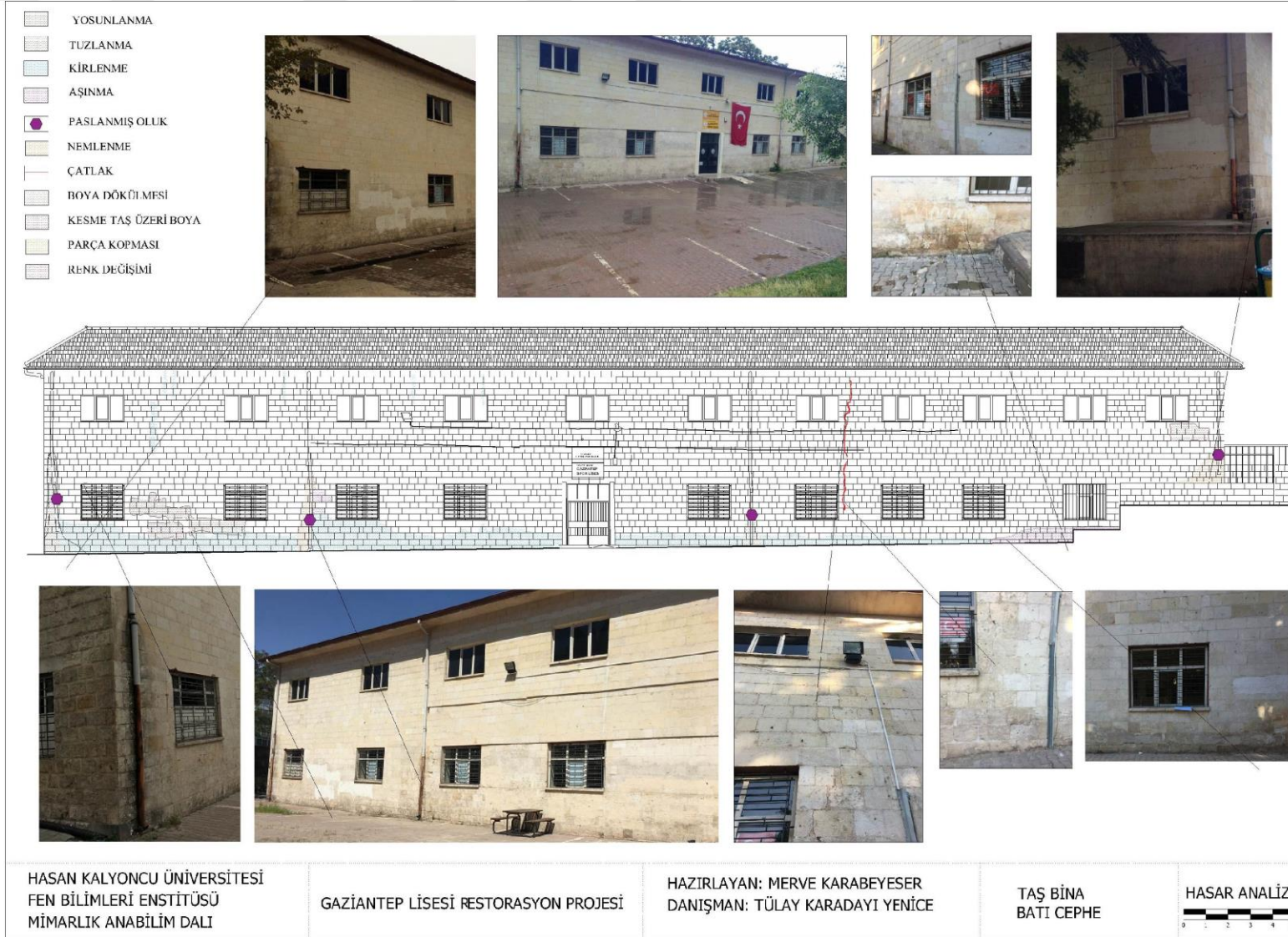
Şekil D 32 Hasar Analizi- Taş Bina Batı Cephe
